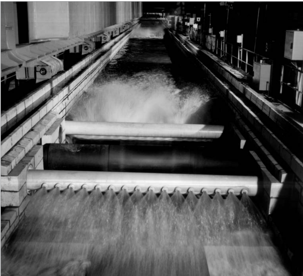
Prétraitement sur une ligne de décapage.
