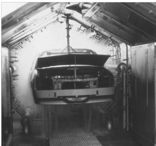
Installation de dégraissage et de phosphatation.
