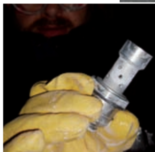
Le nettoyage manuel des buses à l'acide est une action dangereuse.
