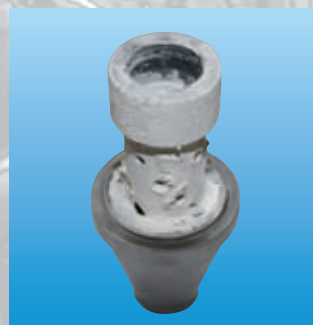
Buse colmatée, suite à un fonctionnement avec du lait de chaux.
