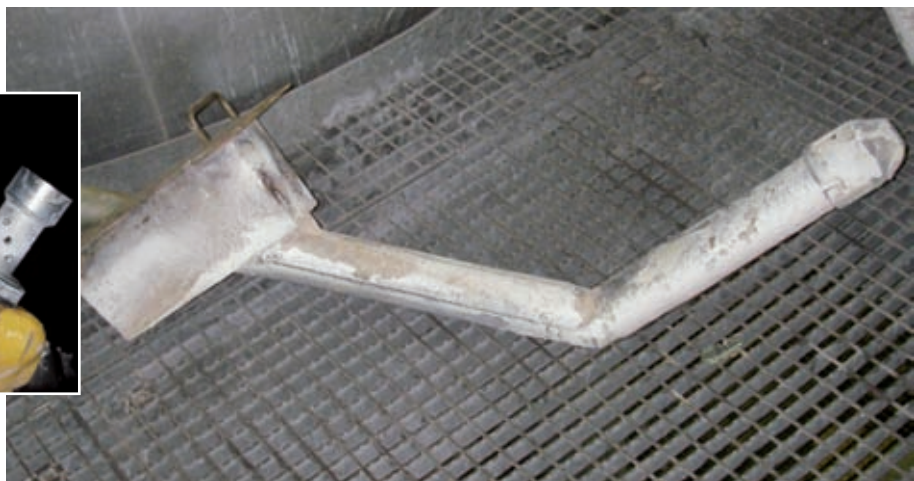
Lances bi-fluides au sein d'un système déjà existant, présentant clairement la nécessité de démonter et de nettoyer les lances fréquemment.
