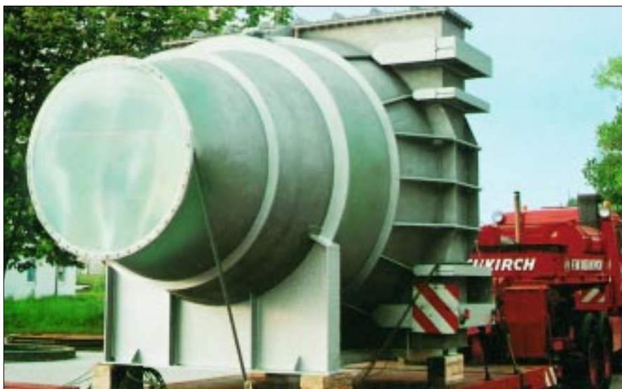
Séparateur de gouttes présenté dans son caisson en acier inoxydable
