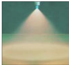
Principe de pulvérisation de la buse à cône plein
